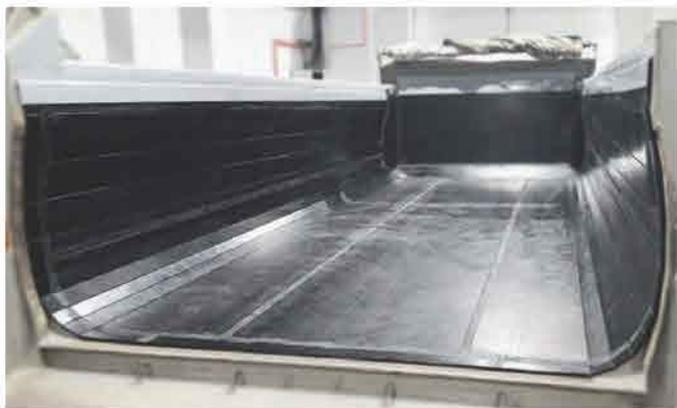
**Футеровка** – это отделка рабочих поверхностей оборудования и деталей материалами со специальными защитными характеристиками от механического, физического, термического и химического воздействия.
